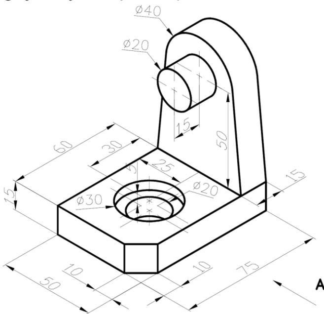
Dadas la siguiente perspectiva y sabiendo que se te indica con una A qué sería el alzado, dibuja las siguientes vistas a escala 1:1 y acotadas según norma: Alzado, planta y corte por el centro de los agujeros en sustitución del perfil lateral derecho.
