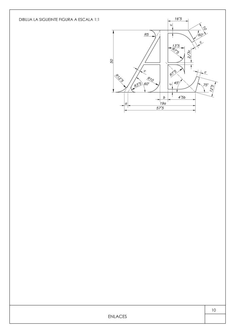
Dada la siguiente figura, dibuja a escala 1:1 y representa los puntos de tangencia y los centros de las circunferencias tangentes. (la parte delantera de la cuchara es un ovoide)
